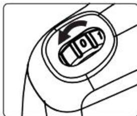
Установите наиболее комфортный для вас уровень звука, повернув колесо регулировки громкости. Поверните в положение 4 при обычном использовании.
